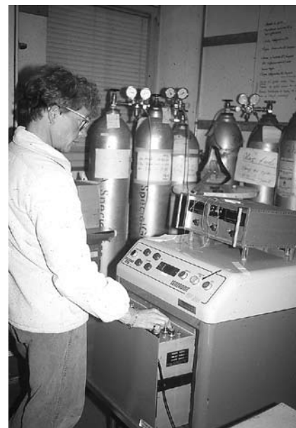
Bild 3 Analys av syre från utandningsluft i masspektrometer. Kalibreringsgaser är nödvändiga.
