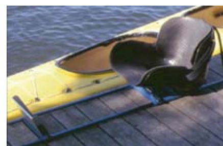
Figur 1. Kajaksits med reglerbart rygg- och fotstöd.
