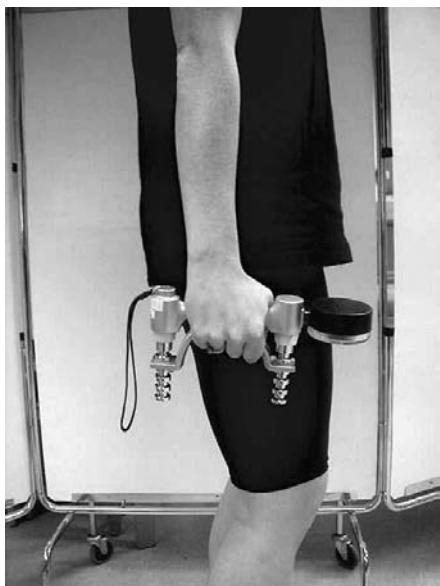
Fig. 2. Test av handgreppsstyrka med Grip Strength Dynamometer® (Cardionics, Bandhagen). Foto: Cecilia Fridén
